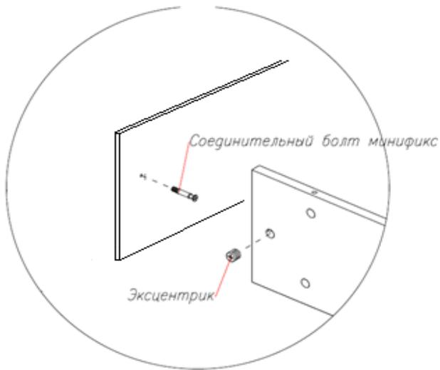
В отверстия 5 мм вкрутите соединительные болты минификсы (3 шт.). В отверстия 15 мм вставьте эксцентрики (3 шт.). На стенках эксцентрики должны быть с внешней стороны, на стойках - с внутренней стороны.
