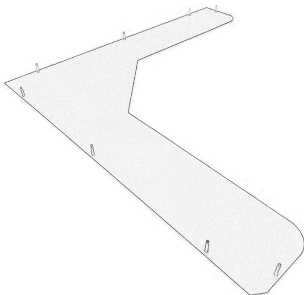
**Е.** В верхнюю плиту в отверстия 5 мм вкрутите соединительные болты минификсы (8 шт.). Установите плиту на стенки и стойки. Зафиксируйте эксцентрики (8 шт.).
