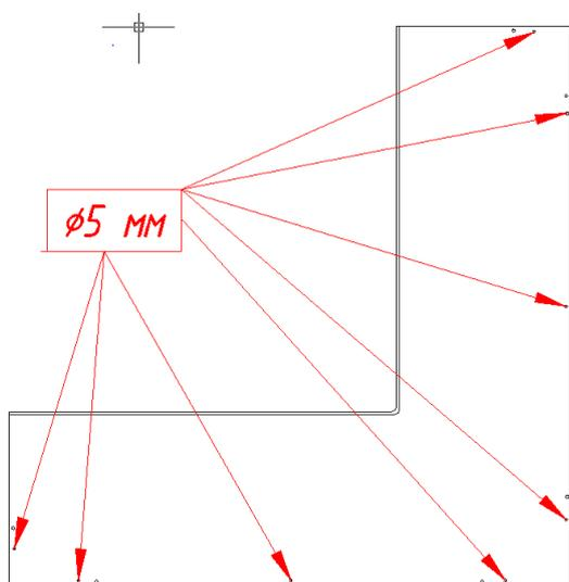
**Д.** В нижнюю плиту в отверстия 5 мм вкрутите соединительные болты минификсы (8 шт.). Установите на минификсы соединённые между собой стенки и стойки. Зафиксируйте эксцентрики (8 шт.).
