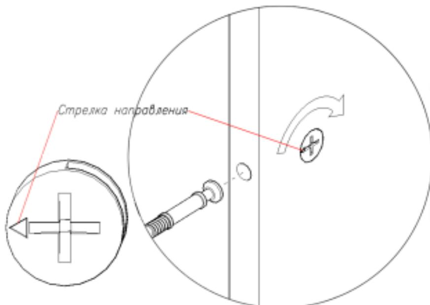
**С.** Соедините стенки и стойки между собой, вставив минификс в отверстие 7 мм, которое соединяется с отверстием 15 мм для эксцентрика (стрелка на эксцентрике должна быть направлена в сторону отверстия для минификса). Установите в отверстие 15 мм эксцентрик и поверните его по часовой стрелке, зафиксировав соединения.
